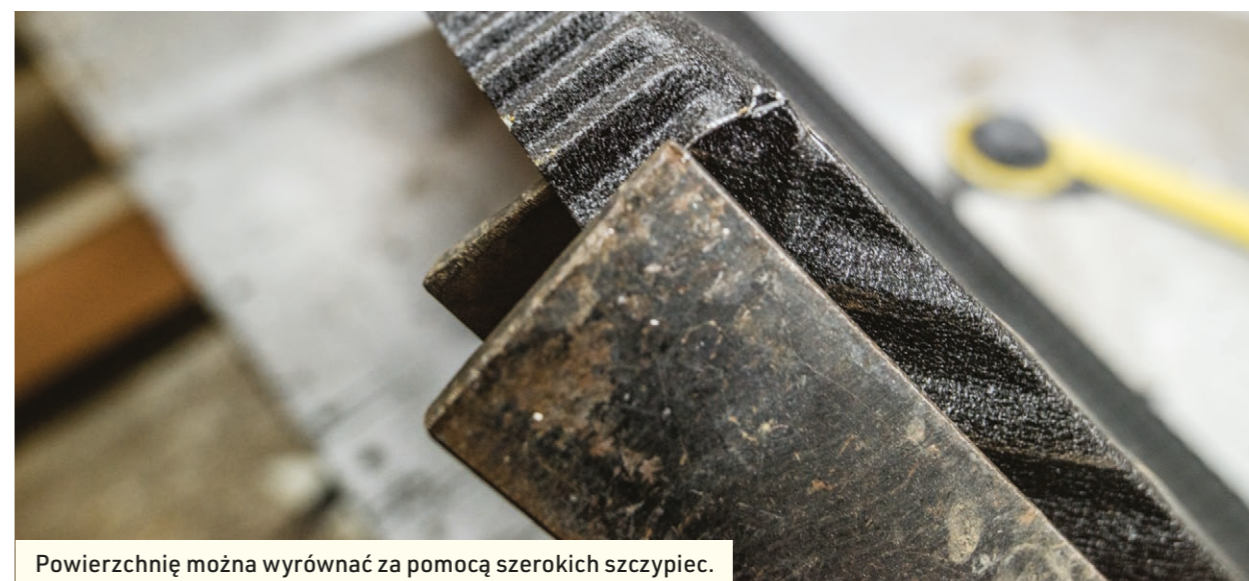
Czoło panelu razem z dogiętą częścią boczną należy wyrównać poprzez obcięcie rogu.
